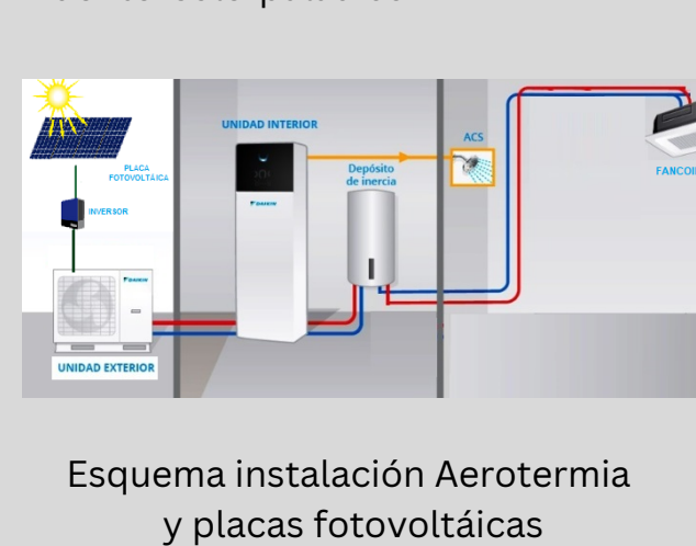
Esquema instalación Aeroterminia y placas fotovoltaicas
